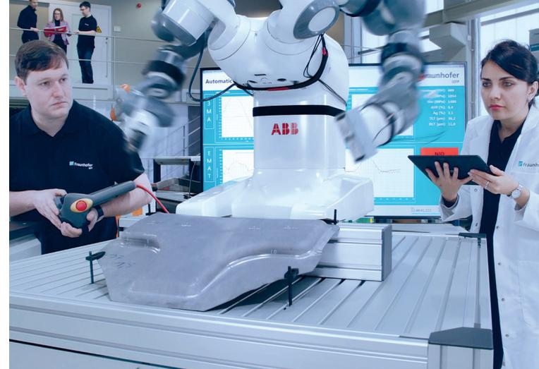
Prüfung von CFK-Komponenten mit Sampling Phased Array
